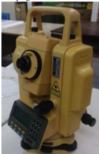
Figura 2 - Estação total empregada em levantamentos topográficos de campo.
