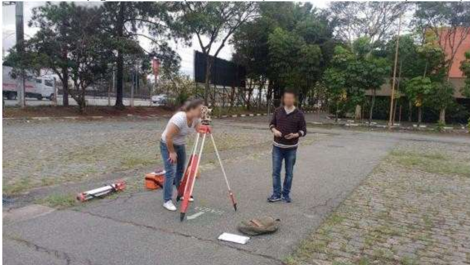
Figura 1 - Levantamento topográfico em campo com utilização de teodolito mecânico para medição de ângulos.
