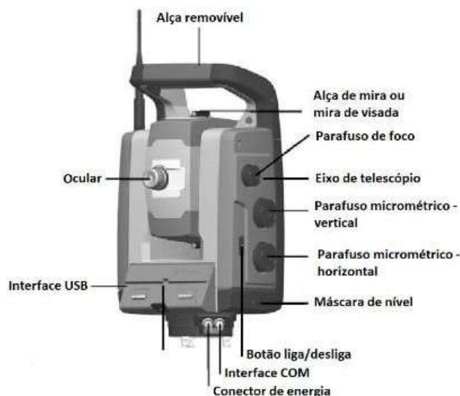
Figura 3 - Principais componentes de uma estação total.
