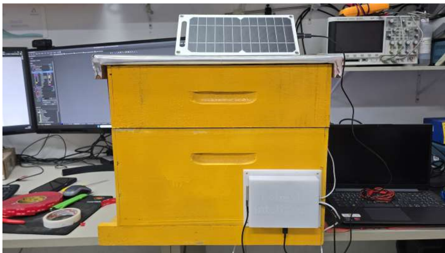
Figura 4.3: Protótipo acoplado na colmeia Langstroth.
