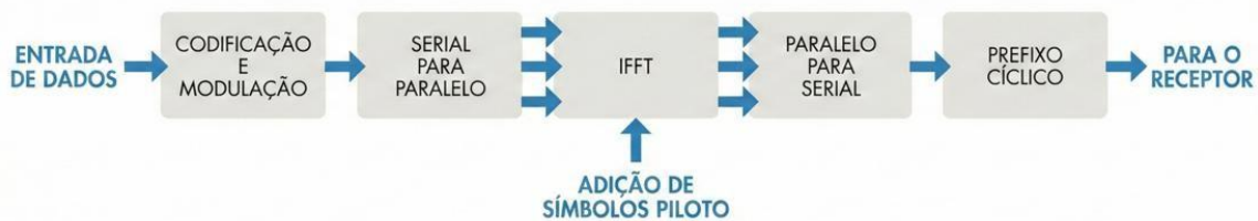
Figura 2: Diagrama em blocos do transmissor OFDM.
