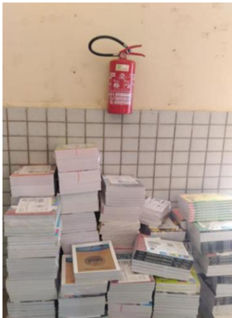
Figura 14 - Unidades extintoras obstruídas: (a) Melo Neto, Borges e Pereira (2021); (b) Freitas (2025).
