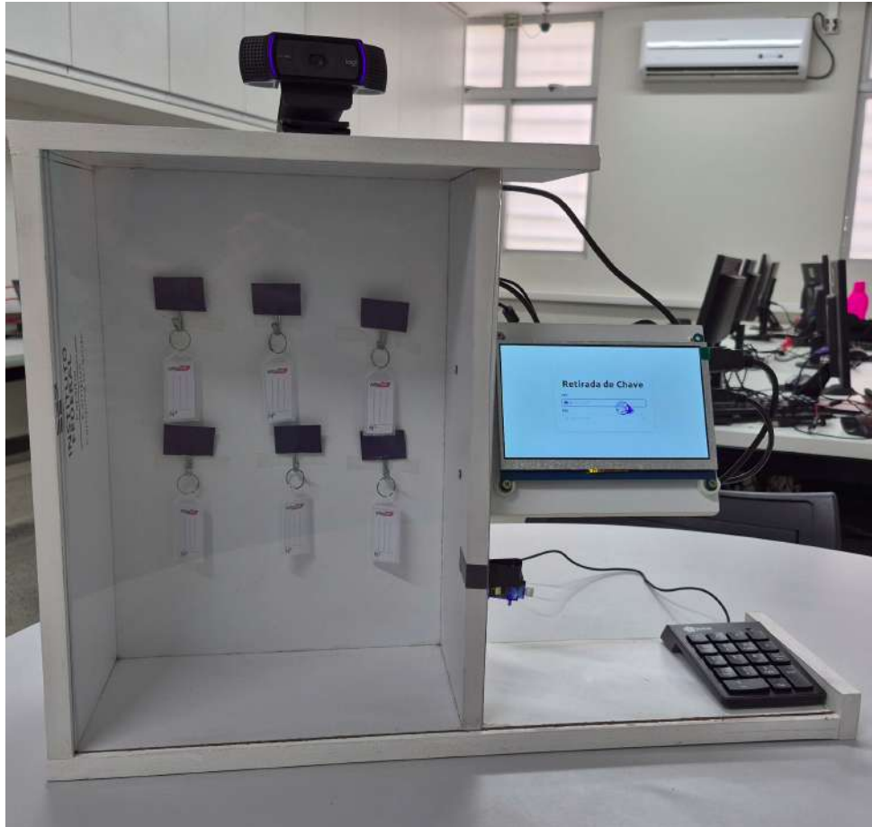
Figura 18: Visão frontal do protótipo mostrando armário de chaves, terminal e webcam
