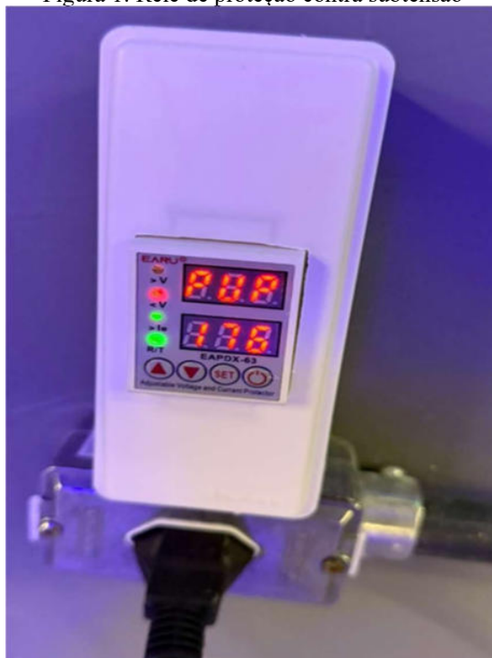
Figura 1: Relé de proteção contra subtensão
