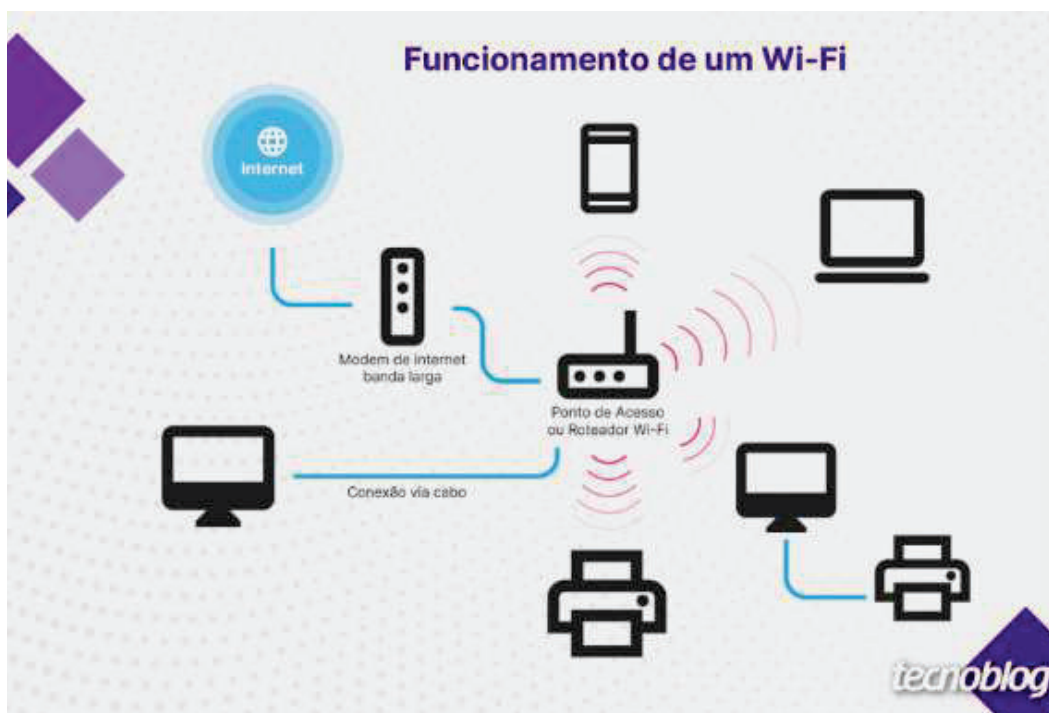
Figura 2: Funcionamento básico de uma rede Wi-Fi
