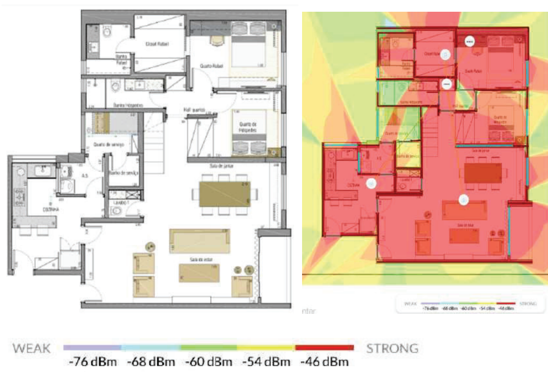
Figura 4: Mapa de propagação do sinal Wi-Fi planta baixa em múltiplos cômodos.
