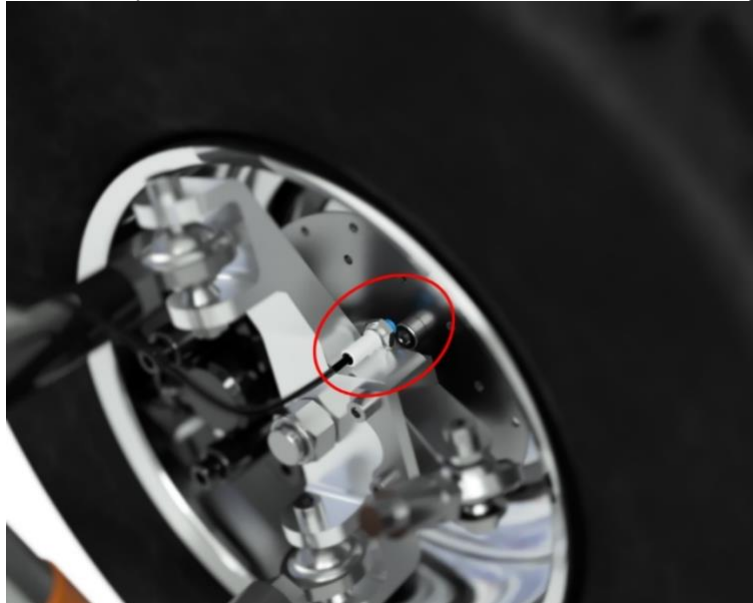
Figura 5 – Instalação do sensor indutivo de velocidade na roda dianteira esquerda.
