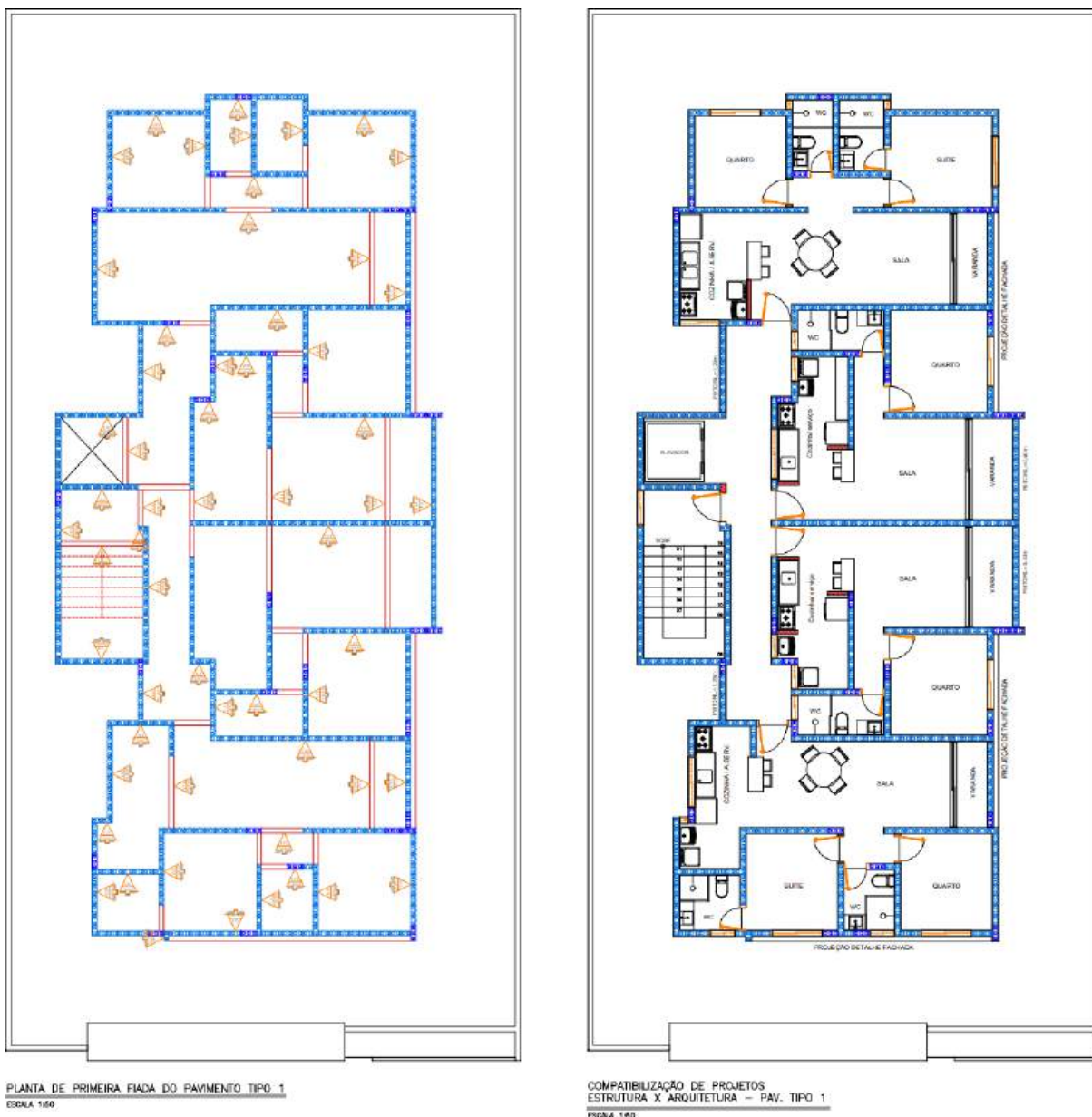
Figura 7 - Primeira fiada e representação da compatibilização com arquitetônico
