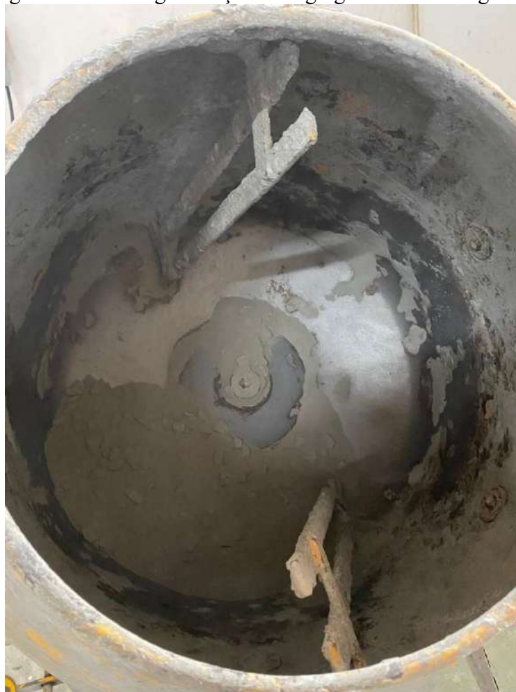
Figura 16 – Homogeneização dos agregados miúdos e graúdos
