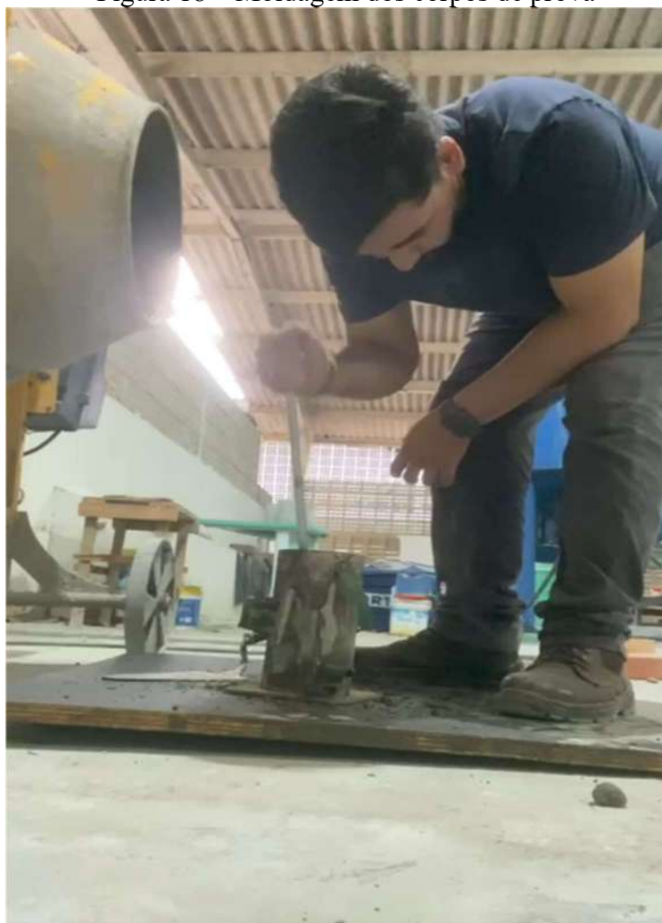
Figura 18 – Moldagem dos corpos de prova
