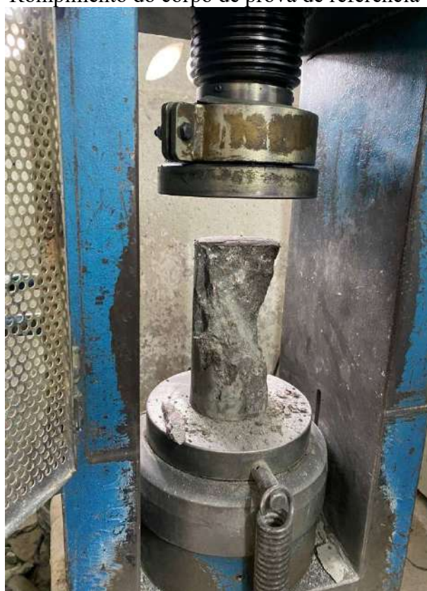
Figura 24 – Rompimento do corpo de prova de referência 0,09% de GO
