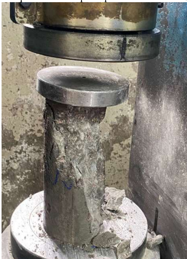
Figura 22 – Rompimento do corpo de prova de referência 0,03% de GO
