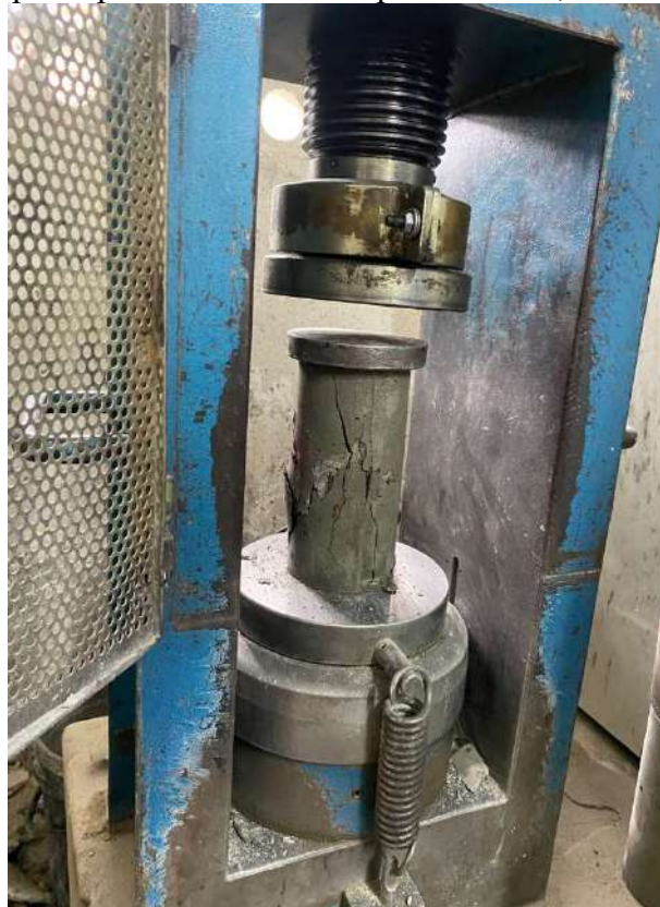
Figura 26 – Corpo de prova de alto desempenho com 0,09% de GO após ensaio
