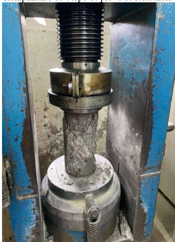
Figura 23 – Rompimento do corpo de prova de referência 0,05% de GO
