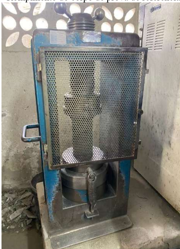
Figura 21 – Rompimento do corpo de prova de referência 0% de GO
