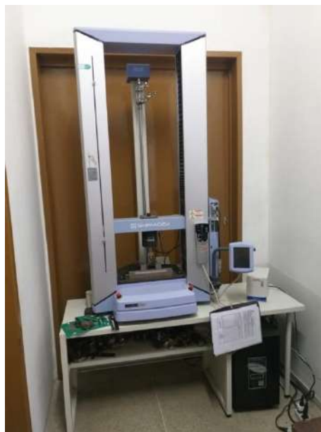
Figura 15 - Máquina Universal de Ensaio montada para execução dos ensaios de Flexão
