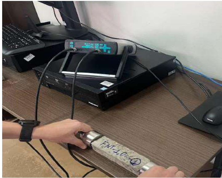
Figura 17 - Execução do Ensaio de Ultrassom
