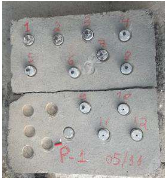
Figura 21 - Colagem das pastilhas para execução do ensaio de resistência à aderência superficial
