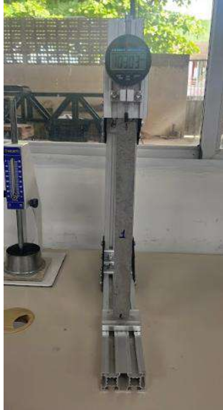
Figura 19 - Medidas dos corpos de prova no ensaio de retração
