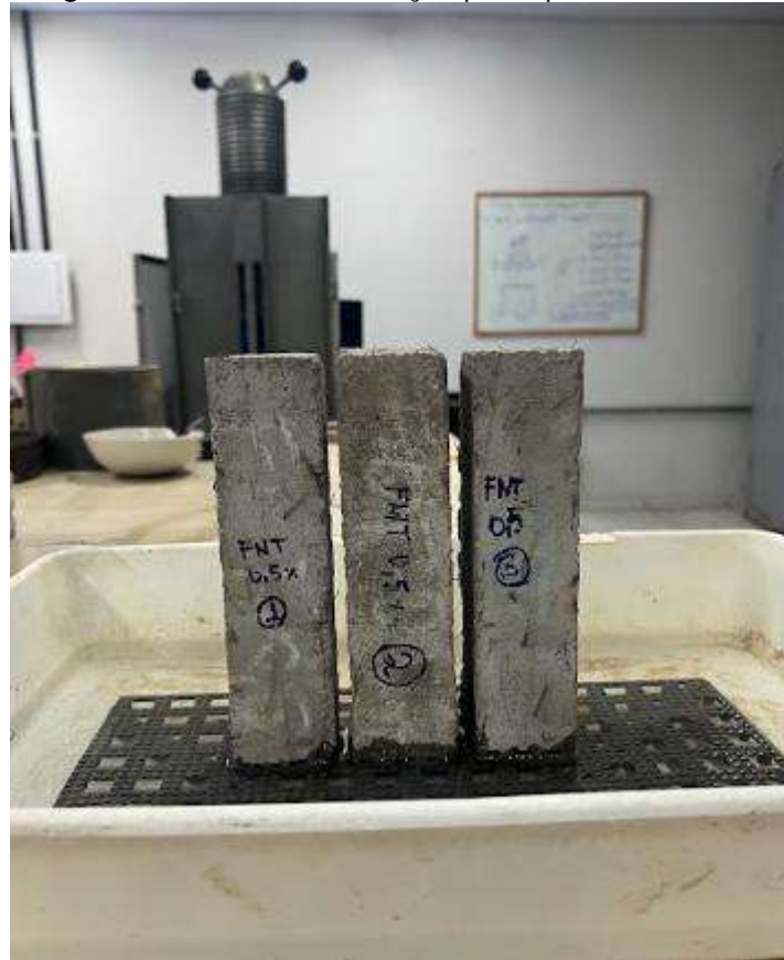
Figura 18 - Ensaio de Absorção por capilaridade
