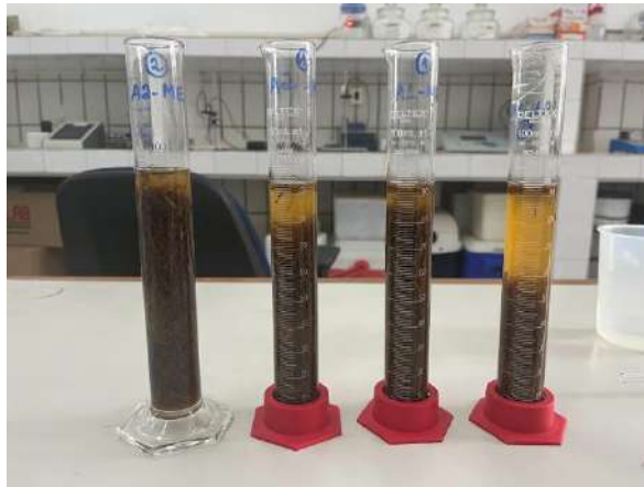
Figura 9 - Determinação da massa específica das fibras
