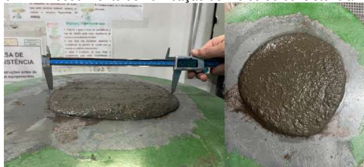
Figura 12 - Procedimento de verificação do índice de consistência
