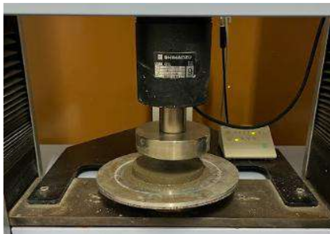
Figura 14 - Execução do Ensaio de Squeeze Flow
