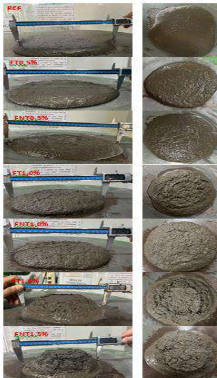
Figura 29 - Ensaios de índice de consistência das misturas analisadas
