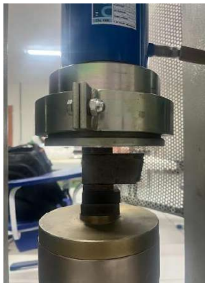
Figura 16 - Ensaio de compressão axial
