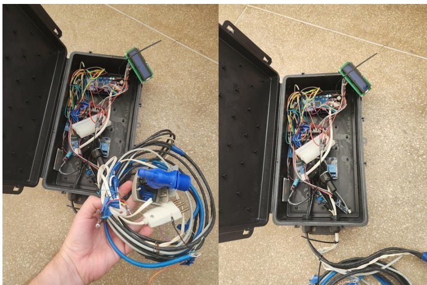
Figura 9 - Sistema eletrônico montado dentro da caixa hermética
