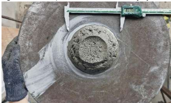
Figura 26 - Aferição dos diâmetros com o paquímetro
