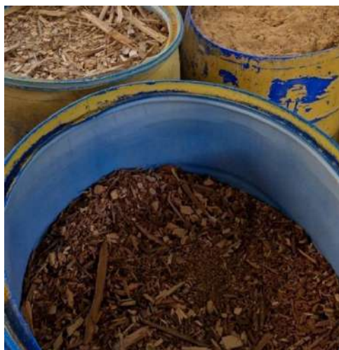
Figura 10 - Dormentes triturados e acondicionados em tonéis, no LABEME
