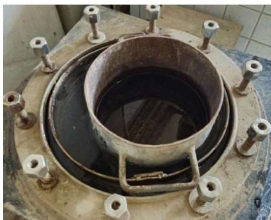
Figura 12 - Lavagem do particulado na autoclave universal
