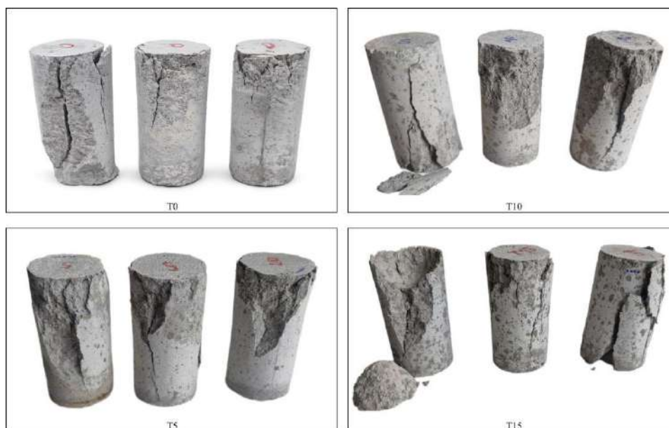
Figura 31 - Corpos-de-prova pós-ensaio de resistência à compressão aos 28 dias
