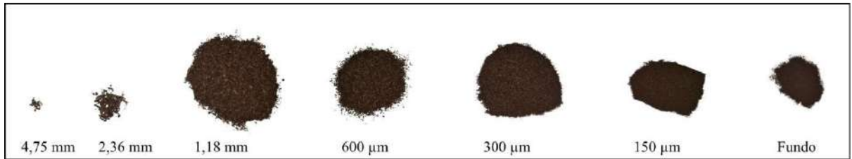
Figura 18 - Partículas retidas em cada uma das peneiras após ensaio
