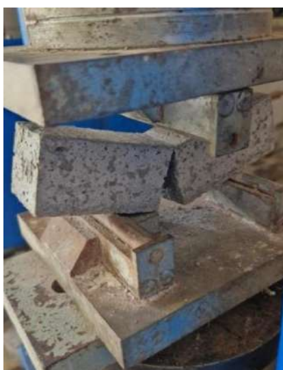
Figura 34 - Ensaio de Resistência à Tração na Flexão aos 28 dias (T15)
