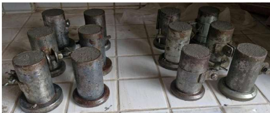
Figura 24 - Corpos de prova cilíndricos (T10 e T5) pós-moldagem
