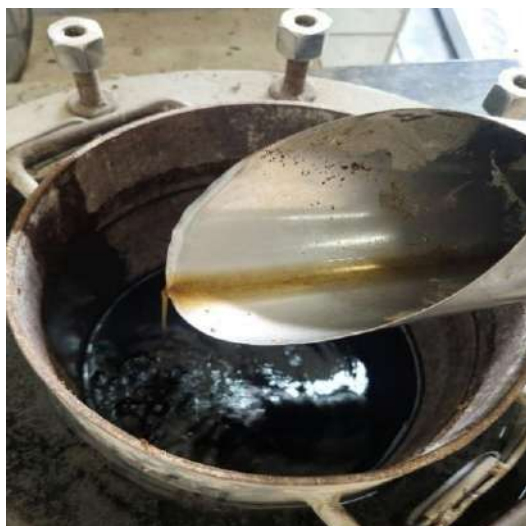
Figura 15 - Coloração da água da lavagem do resíduo
