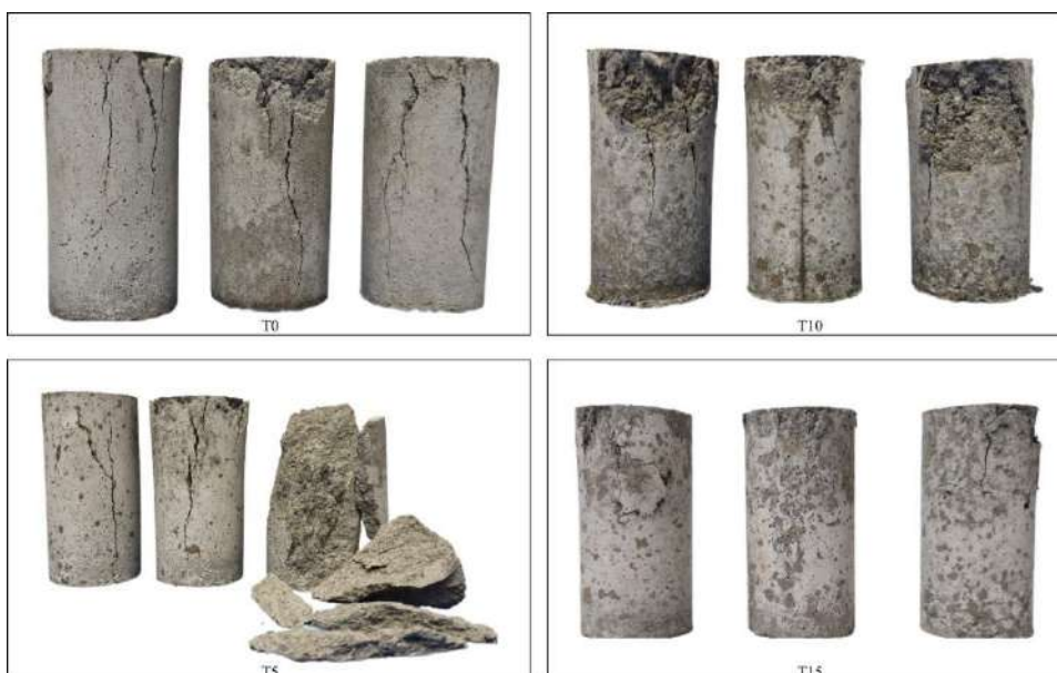
Figura 30 - Corpos-de-prova pós-ensaio de resistência à compressão aos 7 dias
