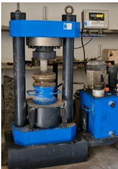
Figura 29 - Ensaio de Resistência à Compressão, prensa da marca Solotest
