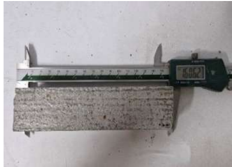
Figura 37- Medição das dimensões dos corpos-de-prova
