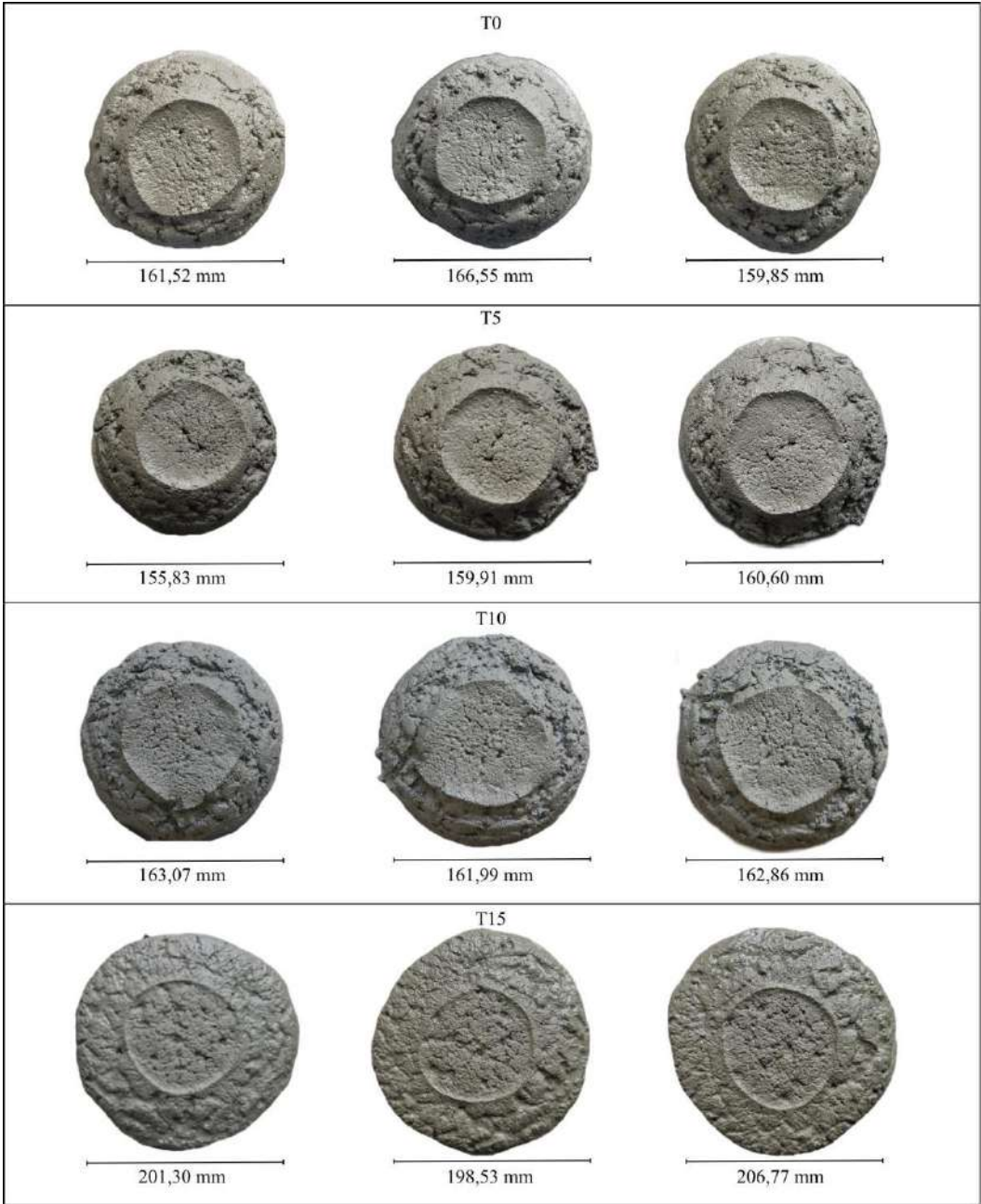
Figura 27 - Diâmetros aferidos para obtenção do Índice de Consistência
