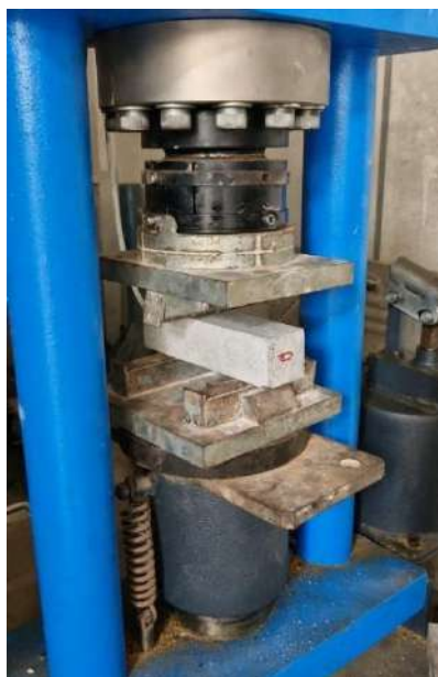
Figura 33 - Ensaio de Resistência à Tração na Flexão aos 7 dias (T0)
