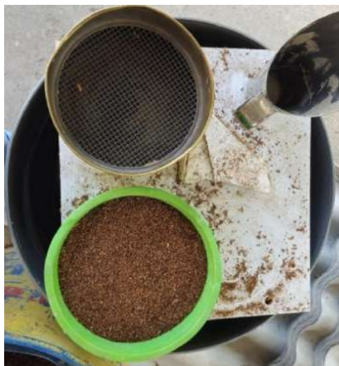
Figura 11 - Partículas peneiradas com peneira de 2,36 mm
