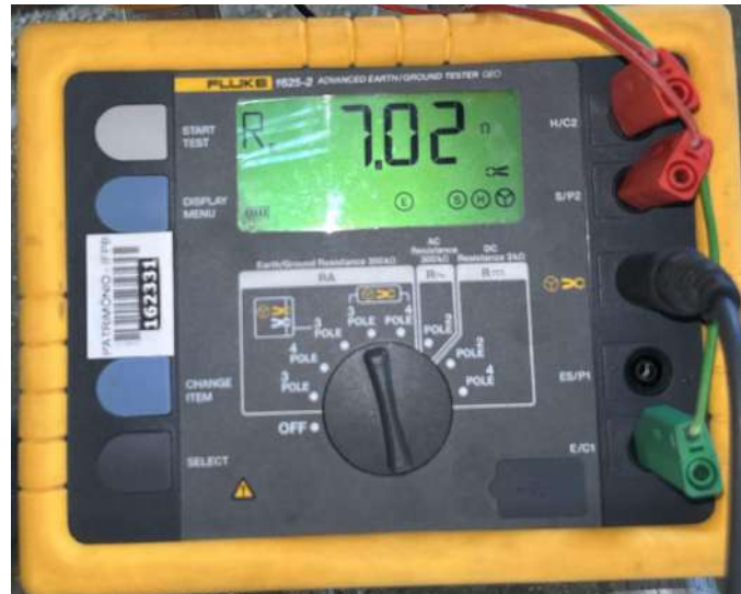
Figura 24: Medição de aterramento da malha modificada.
