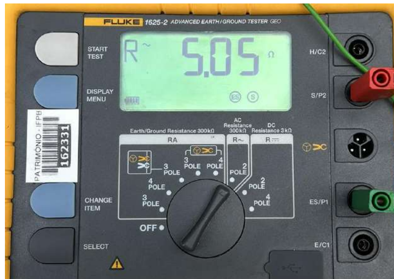
Figura 12: Medição da resistência dos cabos de medição.
