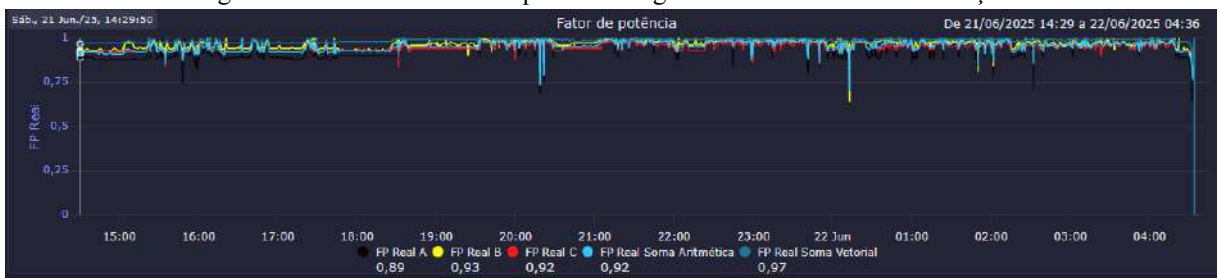
Figura 43: Gráfico do fator de potência no gerador do sistema de iluminação.
