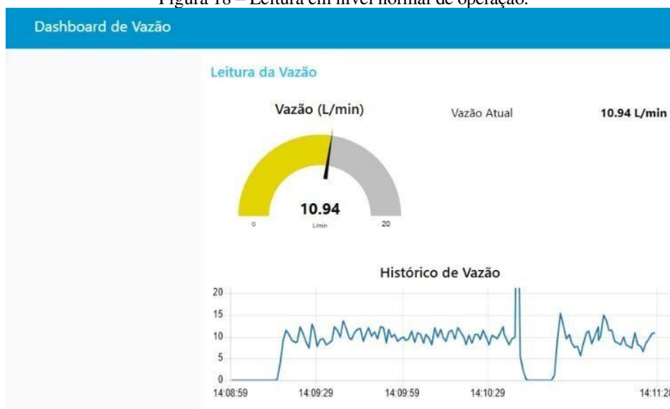
Figura 18 – Leitura em nível normal de operação.
