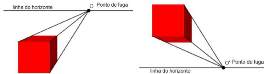
Figura 2.16 – Um cubo em Perspectiva Cônica com um ponto de fuga
