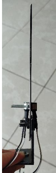
Figura 7 – Dispositivo de sombreamento contendo os sensores LDR.
