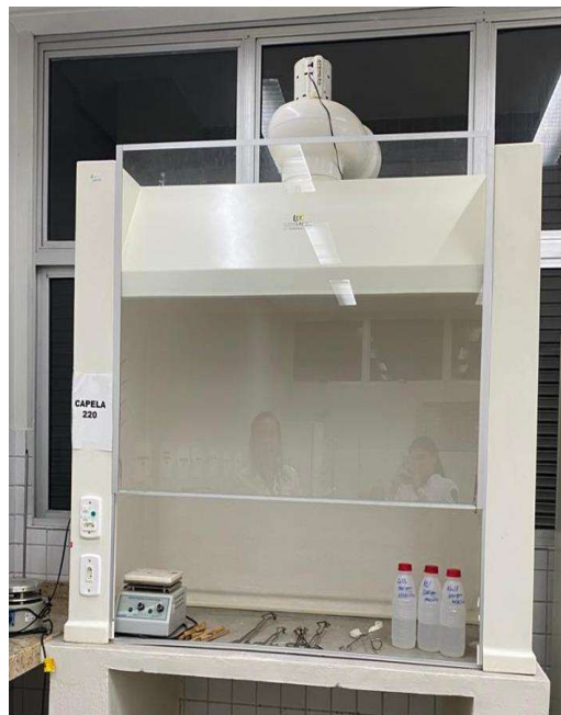
Figura 08: Estrutura da Capela de exaustão
