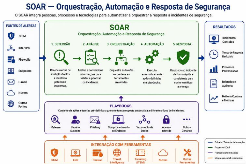
Figura 2.3: Arquitetura conceitual do sistema SOAR. Fonte [Islam 2026]. (Adaptado pelo autor com auxílio de imagem).
