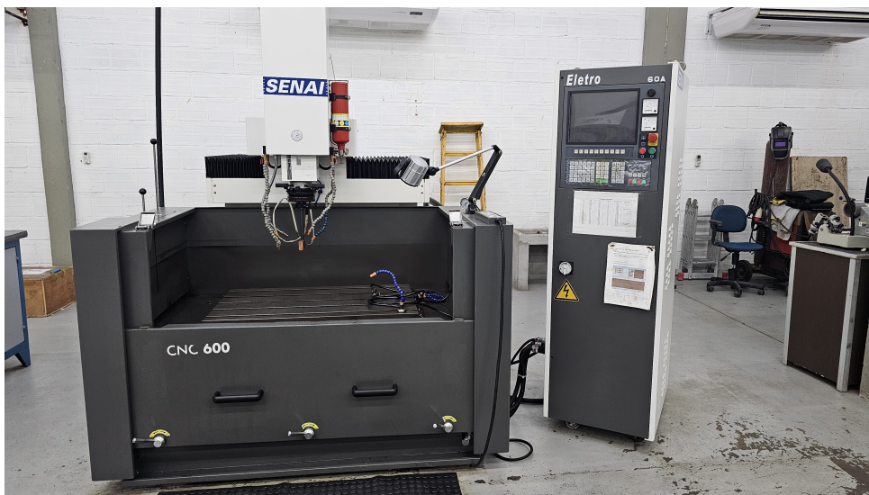
Figura 12 – Máquina de usinagem por eletroerosão, modelo CNC 600.
