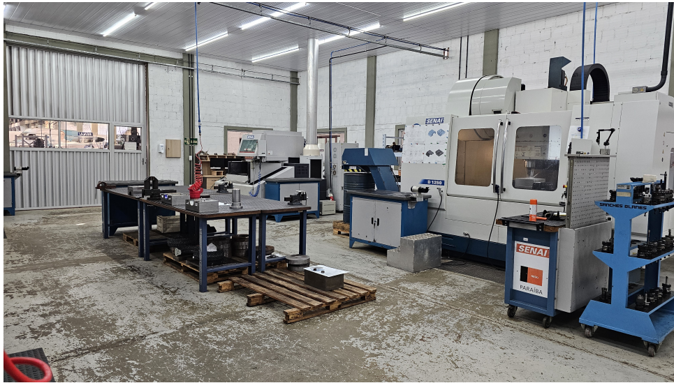
Figura 11 – Visão interna do ambiente industrial do SENAI (CITI/CAM), com destaque para a máquina de usinagem CNC modelo ROMI 1250.
