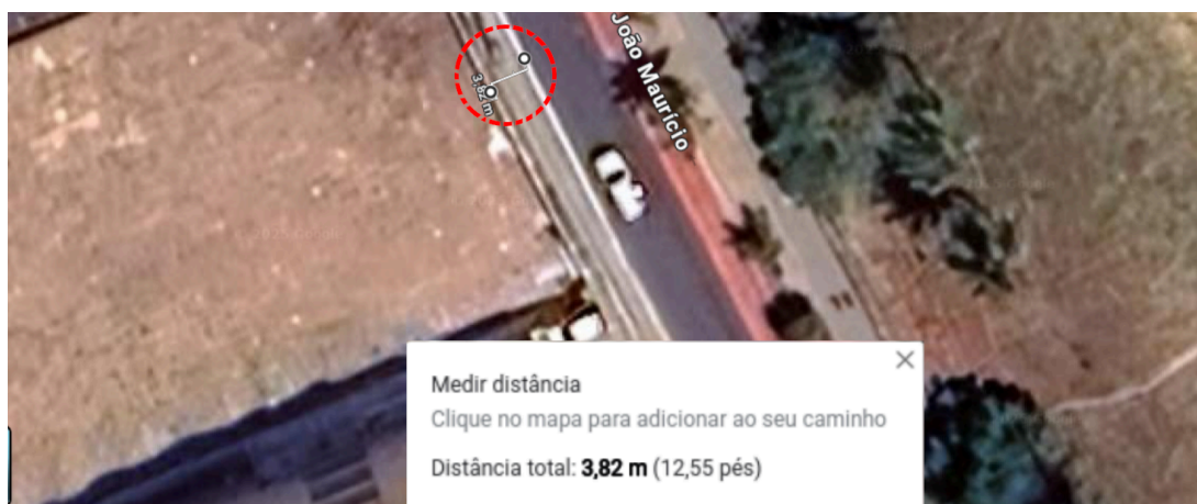
Figura 12 - Exemplo de medição manual da calçada.
