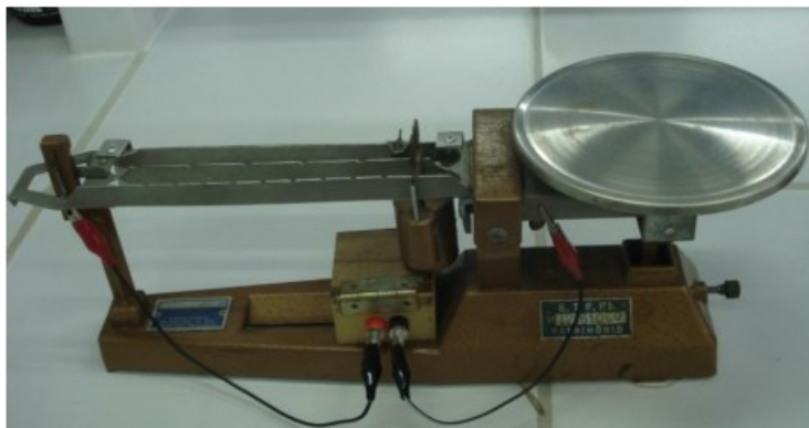
Figura 14. Ligações elétricas para a sinalização sonora de fim de pesagem.
