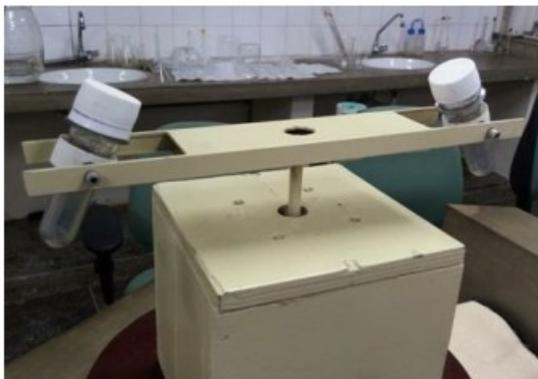
**Figura 3 - Tubos de ensaio (pet's) colocados na centrífuga.
