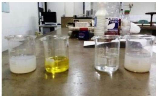
Figura 7. - Solução de  $\text{AgNO}_3$  e  $\text{K}_2\text{CrO}_4$  e solução de NaCl e  $\text{AgNO}_3$ .
