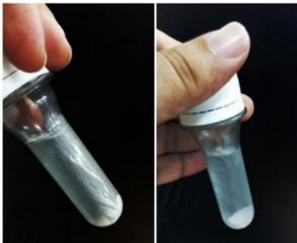
**Figura 12 - Resultado obtido para a reação de NaCl e AgNO<sub>3</sub>.**
