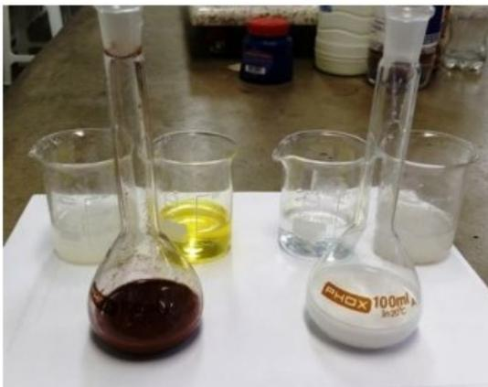
**Figura 8 - Reação de  $\text{AgNO}_3$  e  $\text{K}_2\text{CrO}_4$ , e reação de  $\text{NaCl}$  e  $\text{AgNO}_3$ .**
