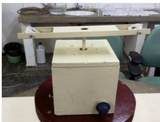
**Figura 2 - Centrífuga construída com materiais alternativos.
