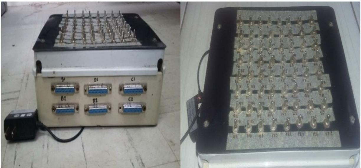
**Figura 5:** Caixa com as chaves liga/desliga/liga e conector DB 25. **Fonte:** autor
