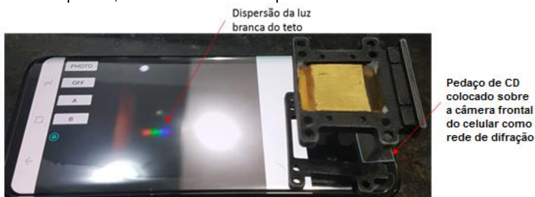
Figura 51. Plataforma montada com o objetivo de observar o espalhamento espectral, fenômeno necessário para o funcionamento do WIM.
